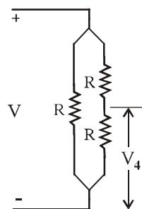
Ποιες από τις τάσεις  $V_1$ ,  $V_2$ ,  $V_3$ ,  $V_4$ , του παραπάνω σχήματος είναι ίσες μεταξύ τους;
